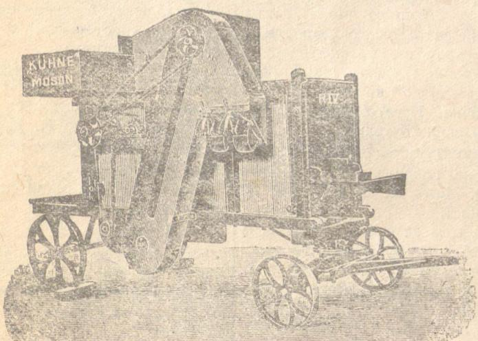
съ вентилаторъ, елеваторъ, чистиленъ апаратъ. Производство дневно 1½ — 2 вагона. Продава се съ лежащо петролно моторче 3 к. с. монтирано на същата колесница.
