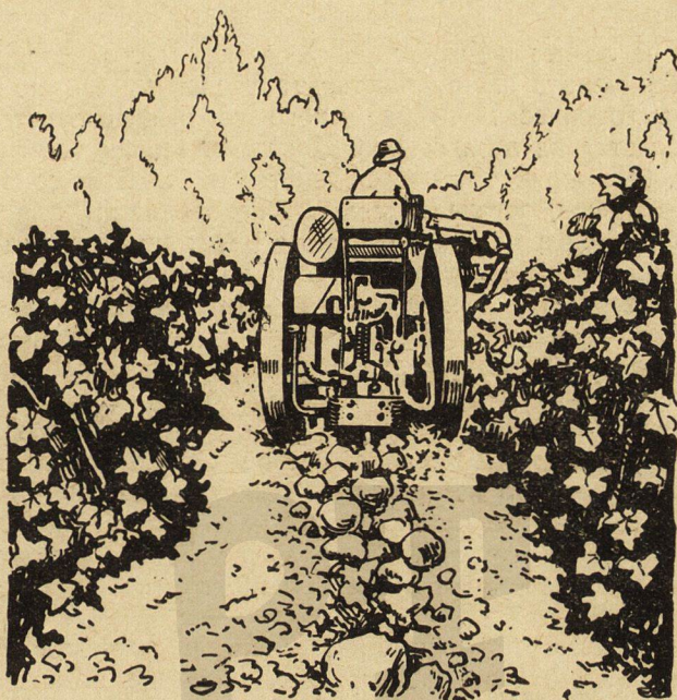
Фиг. 3. Дълбоко разрохкване на почвата между редовете на лозите с Киллефер
