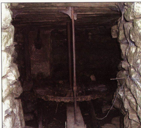
Механизъм за задвижване на воденицата Mechanism for driving the water-mill
