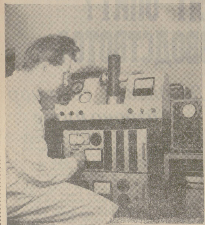
В Института по физична химия при Чехословашката академия на науките е изработена комплексна методика за мерене концентрацията на прах и промишлените аеросоли. С помощта на мембранни филтри автоматично се вземат проби от всички видове промишлени прахове и аеросоли от работните места и от атмосферата около промишлените заводи.
